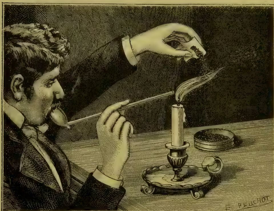
Fig. 197. Limatura di ferro che brucia in una corrente d'aria.
